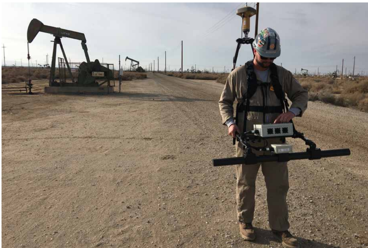
图1 UNISCAN™应用在在美国的一条小管径管线上。
