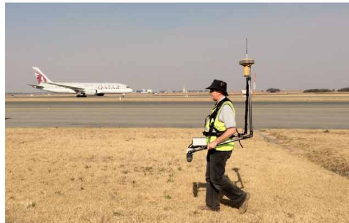
图12：UNISCAN™ 应用在地下管道上，其路线已经由管道定位器标记。
