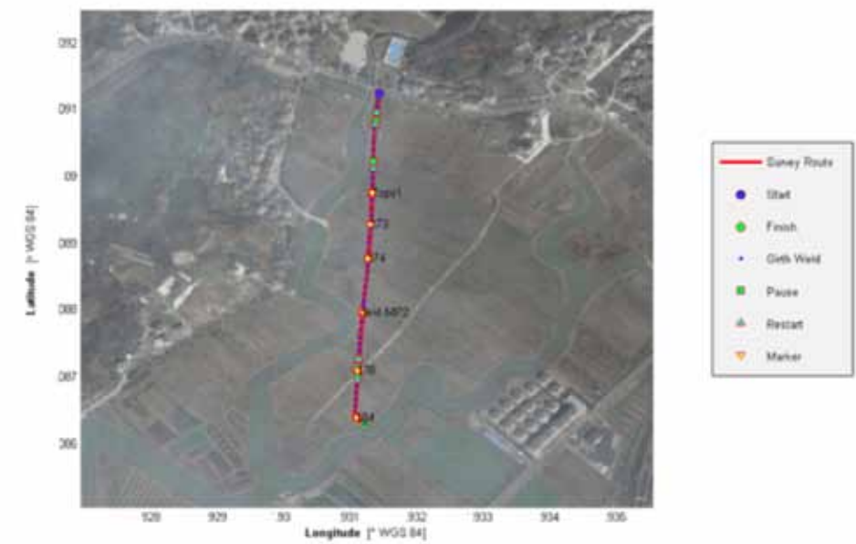
图16：SCT™ 的环形焊缝检测算法映射到管线路径上。环形焊缝由蓝点表示，并映射到管线路径（红线）上。地面标记杆以黄色三角形表示。为了保护客户信息的机密性，已经对 GNSS 坐标进行了修改。
