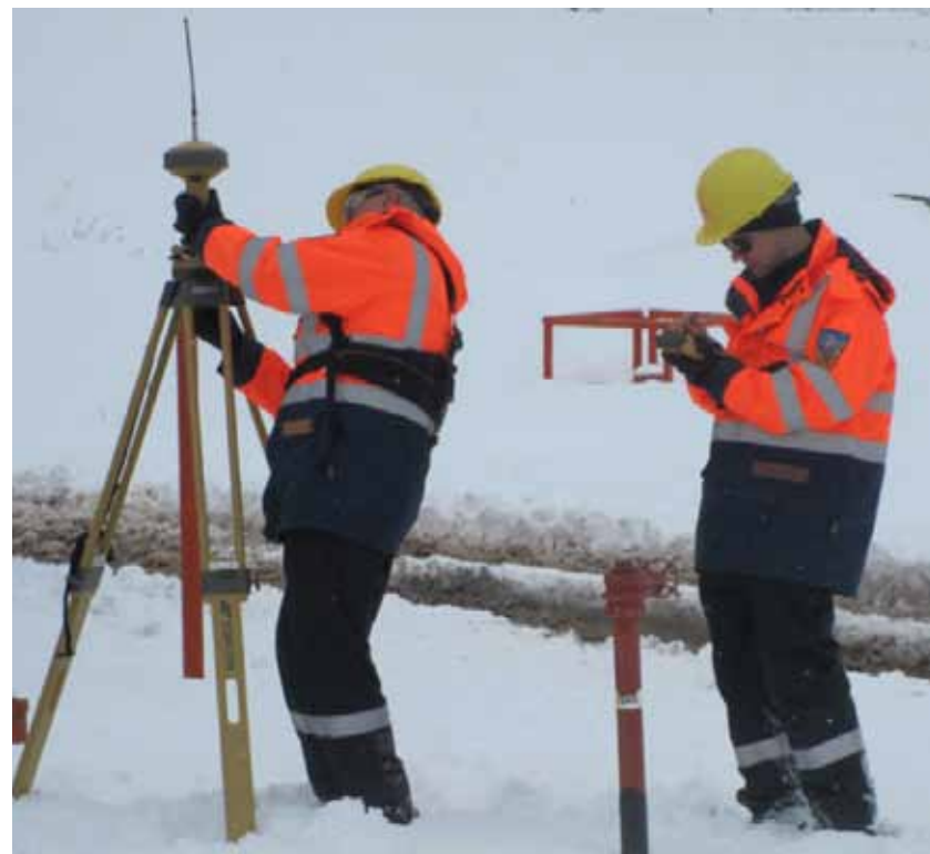
图9：技术人员正在设立基站，基站可接受 GPS 和 GLONASS 卫星的信号向 UNISCAN™ 框架顶端连接的 GNSS 接收器播报其位置。
