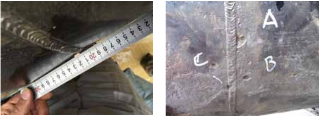
图7： SCT可检测位于环形焊缝上及其附近的缺陷。
