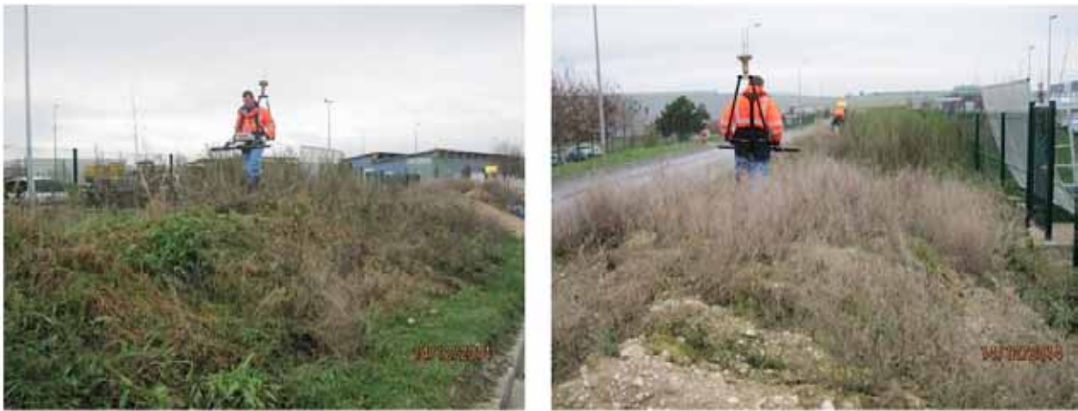
图5 UNISCAN扫描器应用在法国的传输管线上以正常的步行速率行走在崎岖的道路上
