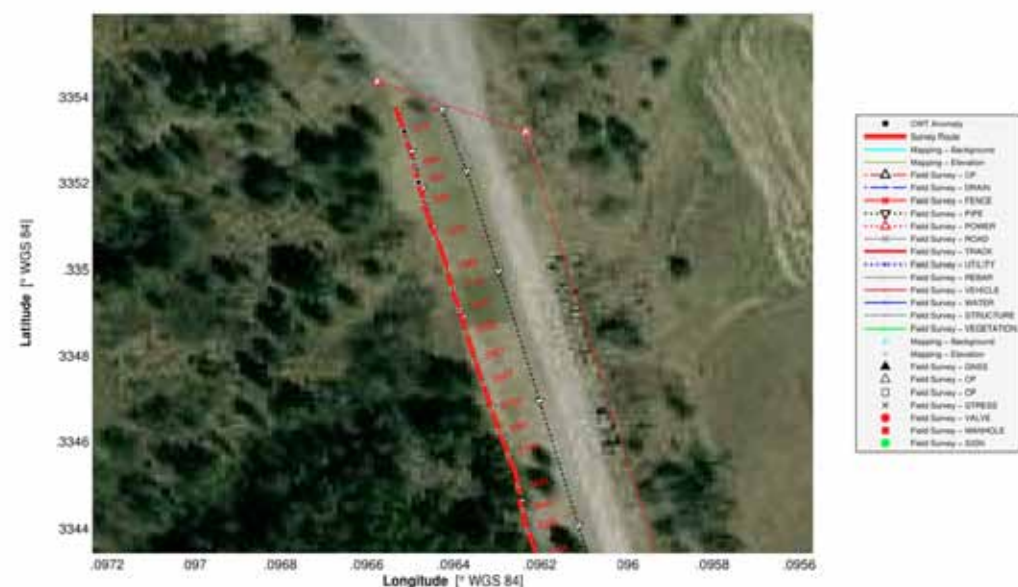
图19: 勘测地图显示了 SCT™ 检测的管道路线的一部分。红线表示测量路线，黑点表示 SCZ，每个SCZ (红色字体表示) 拥有其唯一ID，可以在异常表和带状图中进行交叉比对。为了保护客户信息的机密性，已经删除了图中 GNSS 坐标。
