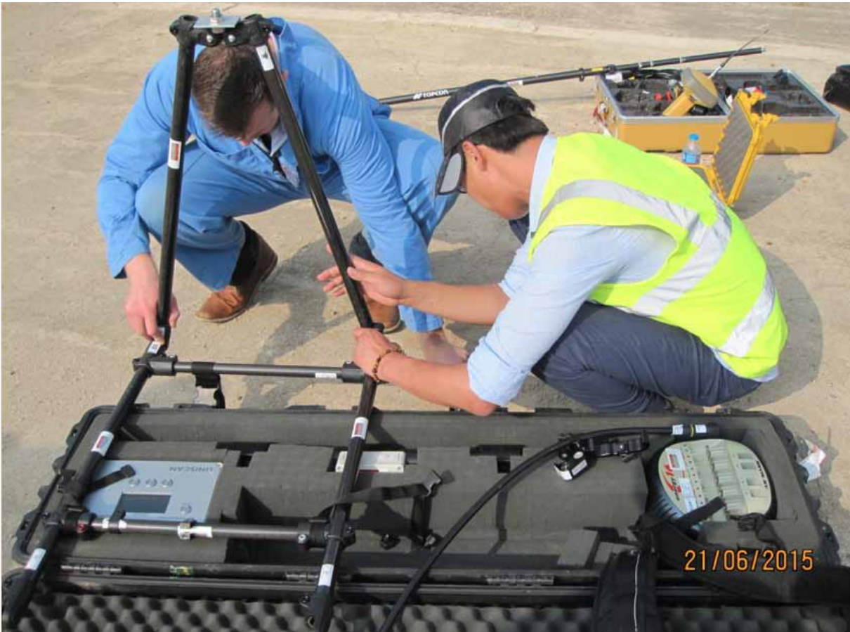
图8：技术人员在组装 UNISCAN™。该设备便于携带，在现场可迅速组装。组装时间约为 10-15分钟。
